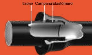
Figura 4 Junta tipo-XT2
