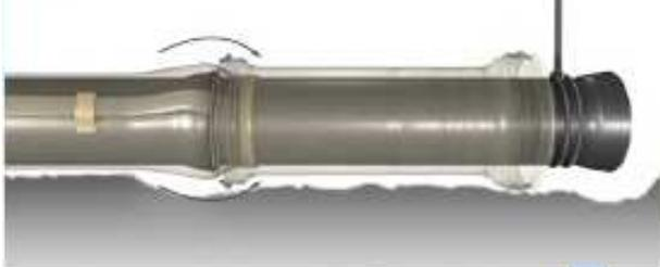
Paso 5: Endereza el exceso de manga al final de la espiga, extiéndelo y envuelve la junta. Después amontona el resto al final del tramo;
