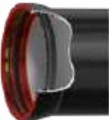
Figura 16 Instalación del Tapón Trasero
