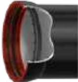
Figura 15 Instalación del anillo de soporte
