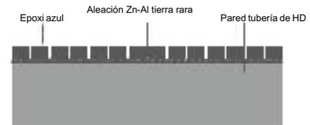
Figura 17 Estructura porosa del recubrimiento de aleación Zn-Al con tierra rara + capa epoxi azul
