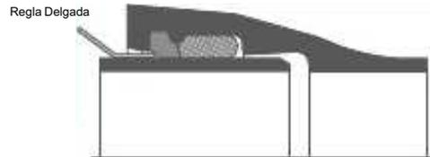
Figura 11 Inspección de la colocación del 'gasket'
