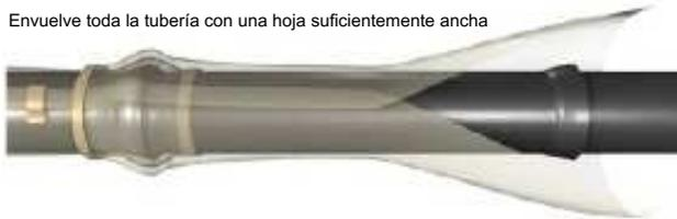
Nota: si este método es aplicado a tubería atornillada, una capa de manga de politetileno de protección se debe agregar a las juntas;
